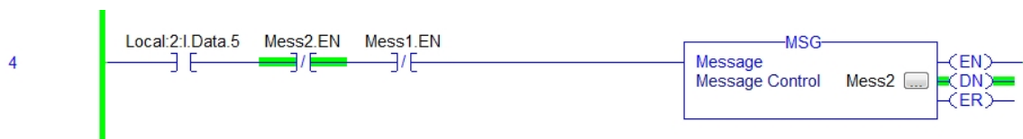
Figure 36-A MSG Mess2 – Source Processor
